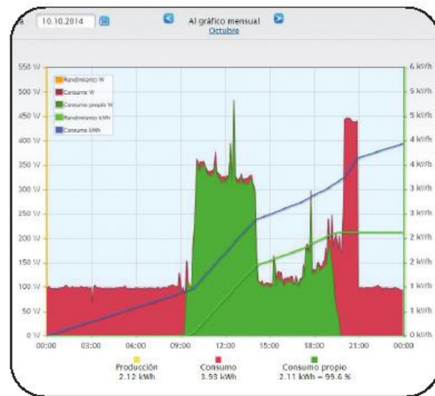
Este gráfico permite observar a autossuficiência da “Senginor” em matéria energética, entre as 09h00 e as 20h00. A vermelho encontra-se o consumo de energia da empresa, e a verde o consumo que é garantido pelo sistema de painéis solares instalados. Como se vê, no pico de funcionamento, a energia produzida cobre totalmente, e chega mesmo a exceder as necessidades.
